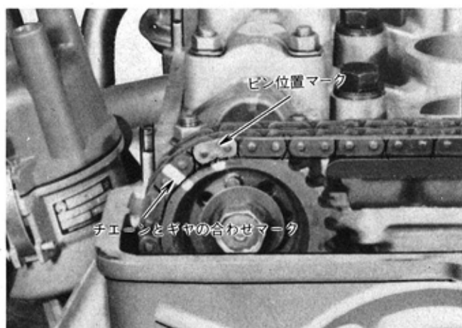
図3-20 タイミング ギヤ取り付け
